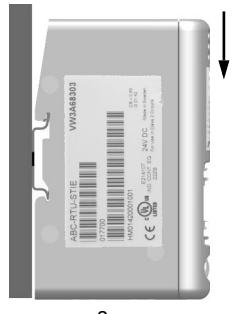
Commencez par appliquer l'embase arrière du coupleur sur la partie supérieure du rail, en poussant vers le bas (1) pour comprimer le ressort du coupleur. Poussez ensuite le coupleur contre le rail DIN (2) jusqu'à ce que l'embase du boîtier du coupleur s'emboîte sur le rail.
