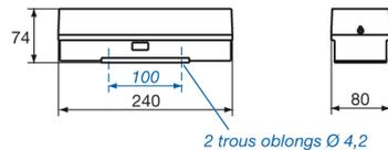
Bloc équipé d'une lampe de veille à Led.
