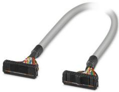
Câble rond pré-équipé; raccordement 1 : IDC/FLK connecteur femelle (1x 26-pôles); raccordement 2 : IDC/FLK connecteur femelle (1x 26-pôles); longueur de câble: 10 m
