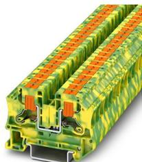
Bloc de jonction pour conducteur de protection, nombre de connexions: 2, nombre de pôles: 1, type de raccordement: Raccordement Push-in, Section de référence: 6 mm<sup>2</sup>, section : 0,5 mm<sup>2</sup> - 10 mm<sup>2</sup>, type de montage: NS 35/7,5, NS 35/15, coloris: vert/jaune
