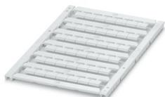
Repères pour blocs de jonction, à commander : sous forme de planche, blanc, impression selon les indications du client, type de montage: encliquetage dans la rainure de repérage plate, pour bloc de jonction au pas de : 8,2 mm, surface utile: 7,4 x 4,7 mm, Nombre d'étiquettes: 42
