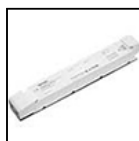
S.2403 ALIMENTATION ELECTRONIQUE NON GRADABLE 100W 230Vac/24Vdc IP20 Entrée: 230V Courant alterné Sortie: 24V Courant continu. Le nombre maximum d'appareils dépend de la somme des puissances unitaires de l'appareil. CLASSE II SELV Dimensions: 295 x 43 x 29,8 mm L'UTILISATION DU DÉCHARGEUR À SURTENSION S.2499 EST RECOMMANDÉE POUR CHAQUE BALLAST ÉLECTRONIQUE QUI DOIT ÊTRE INSTALLÉ À UNE DISTANCE MAXIMALE DE 10m DE CELUI-CI.
