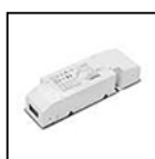
S.2400 ALIMENTATION ELECTRONIQUE NON GRADABLE 35W 230Vac/24Vdc IP20 Entrée: 230V Courant alterné Sortie: 24V Courant continu. Le nombre maximum d'appareils dépend de la somme des puissances unitaires de l'appareil. CLASSE II SELV Dimensions: 195 x 43 x 30,2 mm L'UTILISATION DU DÉCHARGEUR À SURTENSION S.2499 EST RECOMMANDÉE POUR CHAQUE BALLAST ÉLECTRONIQUE QUI DOIT ÊTRE INSTALLÉ À UNE DISTANCE MAXIMALE DE 10m DE CELUI-CI.
