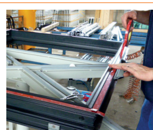
Collage de vitrage avec du ruban 3M™ VHB™
