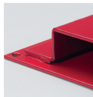
Collage de raidisseur avant passage en peinture poudre
