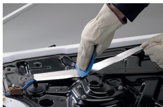
Traitement des vibrations et du bruit à l'intérieur d'un moteur
