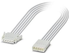
Connecteurs mâles pour C.I. câblés / Câble de connexion avec 2 connecteurs mâles pour C.I., courant de référence: 6 A, longueur de câble: Longueur au choix (0,1 ... 3,0 m), Tête 1: 2-pôles, pas: 2,5 mm, Raccordement à sertir, Connecteur femelle, Coloris: blanc, Type de câble: Toron individuel, PVC, 22 AWG, blanc, Tête 2: 2-pôles, pas: 2,5 mm, Raccordement à sertir, Mâle, Coloris: blanc, Type de câble: Toron individuel, PVC, 20 AWG, blanc, Toron individuel, PVC, 22 AWG, blanc
