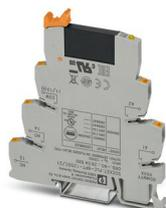
Interface PLC, comprenant le module de base PLC-BPT.../21 avec raccordement Push-in et relais à semi-conducteurs miniature enfichable, pour montage sur profilé NS 35/7,5, 1 contact NO, entrée : 125 V DC, sortie : 3-48 V DC/100 mA
