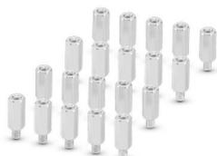
Boulon d'espacement pour fixer le circuit imprimé sur le dissipateur thermique, ouverture de clé : 5, longueur : 10 mm, matériau : acier, surface : galvanisée
