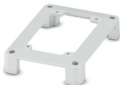
Demi-coque de boîtier pour le montage d'un boîtier UCS de dimensions 125 x 87 mm, avec dissipateur thermique. La demi-coque est préparée pour accueillir un dissipateur thermique UCS HS-HH 125-87 AL, matériau : polycarbonate, coloris : gris clair, similaire à RAL 7035
