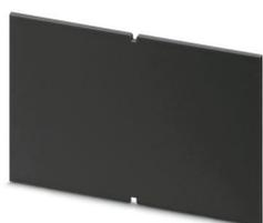
Paroi latérale à utiliser avec les demi-coques de boîtiers de dimension 125 x 87 mm ; épaisseur de paroi : 2 mm ; hauteur totale du boîtier : 47 mm ; matériau : polycarbonate ; couleur noire similaire à RAL 9005
