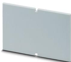
Paroi latérale à utiliser avec les demi-coques de boîtiers de dimension 125 x 87 mm ; épaisseur de paroi : 2 mm ; hauteur totale du boîtier : 67 mm ; matériau : aluminium
