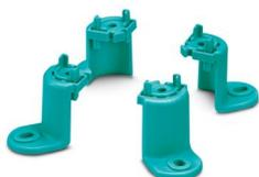
Adaptateur pour la fixation des boîtiers UCS au mur, matériau : polyamide, couleur : bleu turquoise, similaire à RAL 5018, est utilisé à la place de l'insert de montant d'angle UCS CC. Utilisation uniquement avec le dôme autocollant UCS GD 9005
