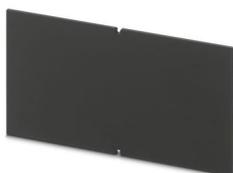
Paroi latérale à utiliser avec les demi-coques de boîtiers dans les dimensions 125 x 87 mm et 145 x 125 mm ; épaisseur de paroi : 2 mm ; hauteur totale du boîtier : 47 mm ; matériau : polycarbonate ; couleur noire similaire à RAL 9005
