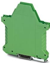
Boîtier électronique sur rail DIN, Partie inférieure du boîtier avec pied métallique de verrouillage, avec contact FE, design élancé, sans fente d'aération, largeur: 12,6 mm, hauteur: 99 mm, profondeur: 107,3 mm, coloris: vert (6021), connexion transversale: sans connecteur de bus, nombre de pôles connecteur transversal: sans objet
