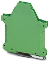
Boîtier électronique sur rail DIN, Partie inférieure du boîtier avec pied métallique de verrouillage, design élancé, sans fente d'aération, largeur: 12,6 mm, hauteur: 99 mm, profondeur: 107,3 mm, coloris: vert (6021), connexion transversale: sans connecteur de bus, nombre de pôles connecteur transversal: sans objet
