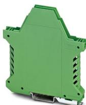
Boîtier électronique sur rail DIN, Partie inférieure du boîtier avec pied métallique de verrouillage, design élancé, avec fentes d'aération, largeur: 12,6 mm, hauteur: 99 mm, profondeur: 107,3 mm, coloris: vert (6021), connexion transversale: sans connecteur de bus, nombre de pôles connecteur transversal: sans objet
