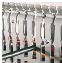
Les goulottes Transcab possèdent des languettes dont les têtes sont rendues non blessantes. L'espace entre 2 languettes est de 6 mm, ce qui permet le passage d'un fil de section 6 mm<sup>2</sup> maxi, sans casse de la languette.
