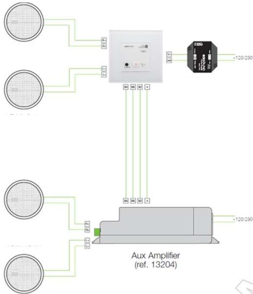
**Exemple 1:** 4 H.P encastrables 2,5" avec amplification additionnelle
