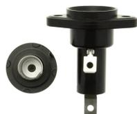
Porte fusible, Basse tension, 30 A, AC 600 V, 1P, UL, CSA, Montage encastré, bouton à visser
