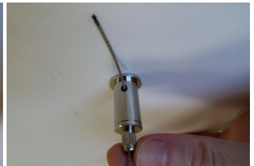
Réglage de la hauteur : - pour raccourcir : pousser le câble vers le plafond. - pour agrandir : dévisser partiellement la petite bague, pousser sur la bague et tirer sur le câble. Revisser.
