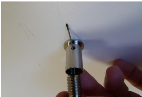
Insérer le câble dans le trou latéral.
