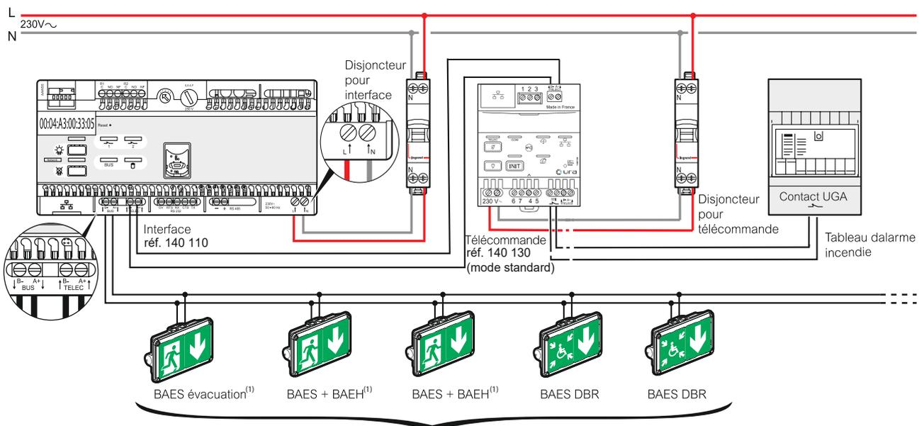
Longueur maxi. d'une ligne de blocs : 700 m. Au delà, placer un répéteur en série avec les blocs suivants
