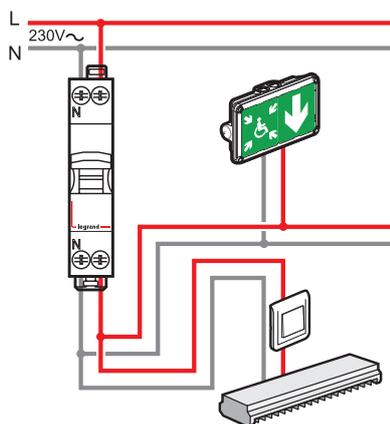
La dérivation peut se faire dans l'armoire électrique, sur l'interrupteur ou dans une boîte de dérivation. L'alimentation des blocs est soumise aux même règle que les luminaires (câblage normal).
