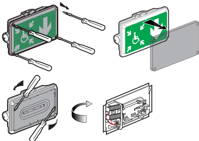
Les accumulateurs doivent être remplacés lorsque le bloc autonome ne satisfait plus à sa durée assignée de fonctionnement.
