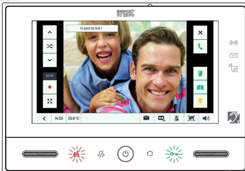
En utilisant les deux flèches en haut à gauche, il est possible de commuter sur toutes les caméras installées.
