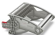
Connecteur d'essai, Un schéma détaillé des connexions est disponible sous Téléchargements Divers, Détrompage de type F19 selon la norme allemande VDE, tension nominale: 400 V, intensité nominale: 24 A, Section de référence: 2,5 mm<sup>2</sup>, coloris: gris
