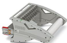
Connecteur d'essai, avec poignée tournante, détrompage de type F19 selon la norme allemande VDE, tension nominale: 400 V, intensité nominale: 24 A, nombre de pôles: 19, Section de référence: 2,5 mm<sup>2</sup>, coloris: gris
