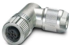
Connecteur de données, CANopen<sup>®</sup>, DeviceNet<sup>™</sup>, 5-pôles, blindé, connecteur femelle coudé M12, détrompage: A, Raccordement à ressort Push-Lock, matériau de la molette: Zinc moulé sous pression, nickelé, diamètre extérieur du câble 4 mm ... 8 mm
