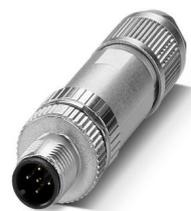
Connecteur de données, CANopen<sup>®</sup>, DeviceNet<sup>™</sup>, 5-pôles, blindé, connecteur mâle droit M12, détrompage: A, Raccordement à ressort Push-Lock, matériau de la molette: Zinc moulé sous pression, nickelé, diamètre extérieur du câble 4 mm ... 8 mm
