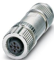
Connecteur de données, CANopen<sup>®</sup>, DeviceNet<sup>™</sup>, 5-pôles, blindé, connecteur femelle droit M12, détrompage: A, Raccordement à ressort Push-Lock, matériau de la molette: Zinc moulé sous pression, nickelé, diamètre extérieur du câble 4 mm ... 8 mm
