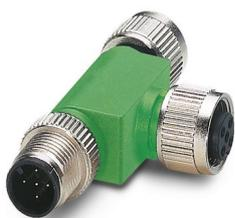
Répartiteur en T, 5-pôles, non blindé, connecteur mâle droit M12, détrompage: A, sur Connecteur femelle droit M12, détrompage: A et Connecteur femelle droit M12, détrompage: A, Répartiteur parallèle
