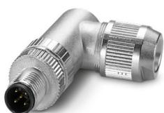
Connecteur de données, CANopen<sup>®</sup>, DeviceNet<sup>™</sup>, 5-pôles, blindé, connecteur mâle coudé M12, détrompage: A, Raccordement à ressort Push-Lock, matériau de la molette: Zinc moulé sous pression, nickelé, diamètre extérieur du câble 4 mm ... 8 mm
