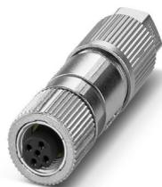
Connecteur de données, CANopen<sup>®</sup>, DeviceNet<sup>™</sup>, 5-pôles, exempt d'halogène, blindé, connecteur femelle droit M12, détrompage: A, Raccordement autodénudant, matériau de la molette: Zinc moulé sous pression, nickelé, diamètre extérieur du câble 5 mm ... 9,7 mm
