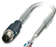
Câble préconfectionné pour bus, CANopen<sup>®</sup>, DeviceNet<sup>™</sup>, 5-pôles exempt d'halogène, blindé, connecteur mâle droit M12 SPEEDCONNECT, détrompage: A, sur extrémité libre, longueur de câble: 2 m, Connecteur non blindé
