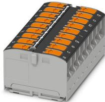
Bloc distributeur, tension nominale: 450 V, intensité nominale: 24 A, nombre de connexions: 18, nombre de pôles: 1, type de raccordement: Raccordement Push-in, Section de référence: 2,5 mm<sup>2</sup>, section : 0,14 mm<sup>2</sup> - 4 mm<sup>2</sup>, type de montage: collage, coloris: noir
