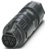
Connecteur prolongateur, Famille d'articles: PRC 35, type: Déverrouillage uniquement avec un outil, coloris: noir, nombre de pôles: 5, section de fil min.: 1,5 mm<sup>2</sup>, section de fil max.: 6 mm<sup>2</sup>, tension de référence: 690 V AC, courant de référence: 35 A, Type de raccordement: Raccordement vissé, Type de contact: Connecteur femelle, diamètre de câble min.: 8 mm, diamètre de câble max.: 21 mm. Variante pour le déverrouillage avec un outil
