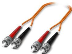
Câble FO équipé, câble Zipcord, fibre de verre multimode 62,5/125 µm, OM1, connecteurs : B-FOC (ST) / B-FOC (ST), indice de protection : IP20, pour goulottes ou armoires électriques
