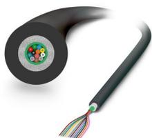
Câble universel GOF, à 12 fils, câble à fibres tubées pour pose fixe, protection anti-rongeurs non métallique, retrait facile, résistant aux UV, capacité de charge mécanique et thermique élevée, fumivore, sans halogène et auto-extincteur, stabilité améliorée, résistance à l'eau longitud. et transv.
