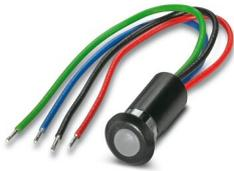
Lampe de signalisation 10 mm avec diode électroluminescente SMD 5 mm (couleurs RVB) à des fins de montage pour des épaisseurs de paroi à partir de 1,5 mm. Boîtier noir en polycarbonate (UL 94-V0) avec 4 extrémités libres de 94 mm étamées, étanche à l'eau IP68 (EN 60529)
