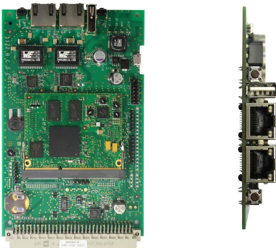
Le raccordement se fait par une liaison Ethernet 10/100 Mbits RJ45 (Compatible 1Gbits) sur IP1.
