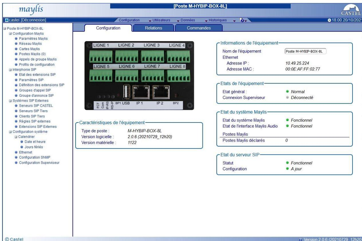
The screenshot shows the web interface for the M-HYB-IP-BOX-8L. The main content area displays a photo of the device with labels for LIGNE 1-8, BP1 USB, IP 1, IP 2, and BP2. The right sidebar shows equipment information (Nom, Adresse IP, Adresse MAC), general status (Etat général: Normal, Connexion Superviseur: Déconnecté), system status (Etat du système Maylis: Fonctionnel), and server status (Statut: Fonctionnel, Configuration: A jour).
