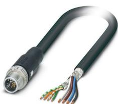
Câble hybride, Ethernet hybride CAT5 (100 Mbit/s), 8-pôles exempt d'halogène, blindé, connecteur mâle droit M12, détrompage: Y SPEEDCONNEC / IP67, sur extrémité libre, longueur de câble: 1 m, Power with Ethernet (PWE)
