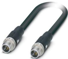
Câble hybride, Ethernet hybride CAT5 (100 Mbit/s), 8-pôles exempt d'halogène, blindé, connecteur mâle droit M12, détrompage: Y SPEEDCONNEC / IP67, sur connecteur mâle droit M12, détrompage: Y SPEEDCONNEC / IP67, longueur de câble: 1 m, Power with Ethernet (PWE)
