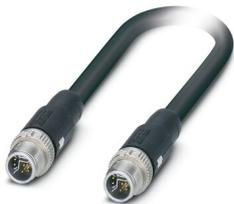
Câble hybride, Ethernet hybride CAT5 (100 Mbit/s), 8-pôles exempt d'halogène, blindé, connecteur mâle droit M12, détrompage: Y SPEEDCONNEC / IP67, sur connecteur mâle droit M12, détrompage: Y SPEEDCONNEC / IP67, longueur de câble: 2 m, Power with Ethernet (PWE)
