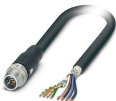
Câble hybride, Ethernet hybride CAT5 (100 Mbit/s), 8-pôles exempt d'halogène, blindé, connecteur mâle droit M12, détrompage: Y SPEEDCONNEC / IP67, sur extrémité libre, longueur de câble: 5 m, Power with Ethernet (PWE)
