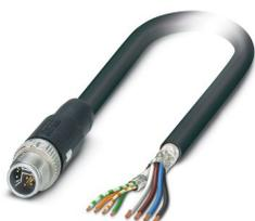
Câble hybride, Ethernet hybride CAT5 (100 Mbit/s), 8-pôles exempt d'halogène, blindé, connecteur mâle droit M12, détrompage: Y SPEEDCONNEC / IP67, sur extrémité libre, longueur de câble: 2 m, Power with Ethernet (PWE)
