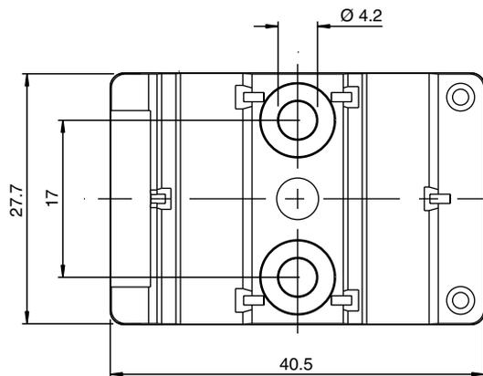
Le dispositif peut être vissé sur une surface de montage plane à l'aide de deux vis de fixation M4. Les vis de fixation ne sont pas fournies.
