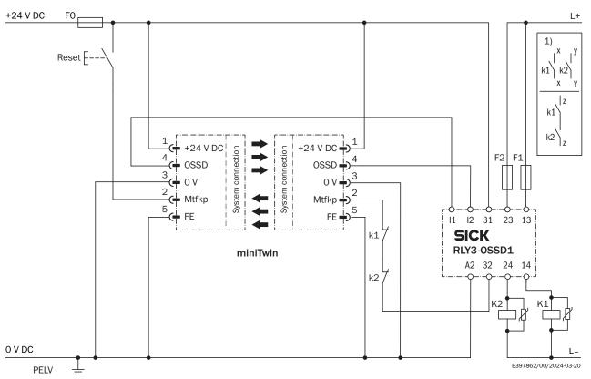
Sicherheitslichtvorhang miniTwin an Sicherheitsrelais RLY3-OSSD1, mit Wiederanlaufsperre und Schützkontrolle
