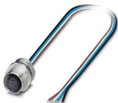
Embases paroi avant, 4-pôles, connecteur femelle, droit, M12, détrompage: A, sur extrémité libre, Montage sur face avant, Cordons individuels, longueur de câble: 3 m, 0,34 mm<sup>2</sup>, Cordon TPE
