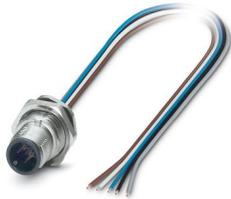
Connecteur d'appareil face arrière, Universel, 5-pôles, Connecteur mâle, droit, M12, détrompage: A, sur extrémité libre, Montage face arrière, M16 x 1,5, Cordons individuels, longueur de câble: 0,5 m, 0,34 mm<sup>2</sup>, Cordon TPE, L'article est sans plomb, conformément à la directive RoHS II, sans exception 6c (Pb < 0,1 %)
