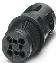
Traversée de paroi, Raccordement QUICKON, nombre de pôles: 3+PE, 400 V, 20 A, noir, sans écrou QUICKON, filetage de montage: M25, Raccordement Push-in, 2,5 mm<sup>2</sup>
