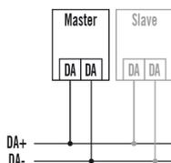
Raccordement maître/esclave. Un appareil maître peut être raccordé à 8 appareils esclaves au maximum.
