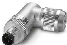
Connecteur, PROFINET CAT5 (100 Mbit/s), 4-pôles, blindé, connecteur mâle coudé M12, détrompage: D, Raccordement à ressort Push-Lock, matériau de la molette: Zinc moulé sous pression, nickelé, diamètre extérieur du câble 4 mm ... 8 mm
