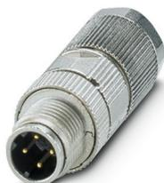
Connecteur de données, PROFINET CAT5 (100 Mbit/s), 4-pôles, blindé, connecteur mâle droit M12, détrompage: D, Raccordement à sertir, matériau de la molette: Zinc moulé sous pression, étamé, diamètre extérieur du câble 4,5 mm ... 7,5 mm, sans contacts à sertir
