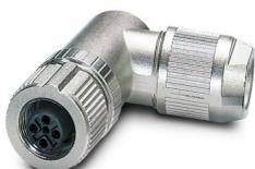
Connecteur, PROFINET CAT5 (100 Mbit/s), 4-pôles, blindé, connecteur femelle coudé M12, détrompage: D, Raccordement à ressort Push-Lock, matériau de la molette: Zinc moulé sous pression, nickelé, diamètre extérieur du câble 4 mm ... 8 mm
