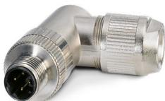
Connecteur de données, PROFINET CAT5 (100 Mbit/s), 4-pôles, blindé, connecteur mâle coudé M12, détrompage: D, Raccordement autodénudant, matériau de la molette: Laiton, nickelé, diamètre extérieur du câble 4 mm ... 8 mm
