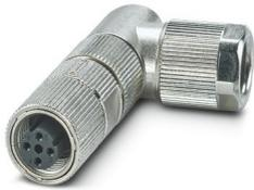
Connecteur de données, PROFINET CAT5 (100 Mbit/s), 4-pôles, blindé, connecteur femelle coudé M12, détrompage: D, Raccordement à sertir, matériau de la molette: Zinc moulé sous pression, étamé, diamètre extérieur du câble 4,5 mm ... 7,5 mm, sans contacts à sertir
