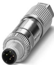
Connecteur de données, PROFINET CAT5 (100 Mbit/s), 4-pôles, exempt d'halogène, blindé, connecteur mâle droit M12, détrompage: D, Raccordement autodénudant, matériau de la molette: Zinc moulé sous pression, nickelé, diamètre extérieur du câble 5 mm ... 9,7 mm
