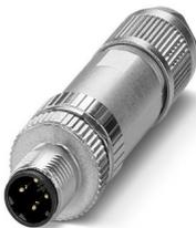
Connecteur, PROFINET CAT5 (100 Mbit/s), 4-pôles, blindé, connecteur mâle droit M12, détrompage: D, Raccordement à ressort Push-Lock, matériau de la molette: Zinc moulé sous pression, nickelé, diamètre extérieur du câble 4 mm ... 8 mm
