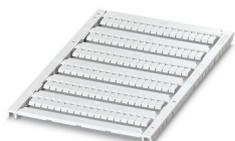
Repères pour blocs de jonction, Planche, blanc, vierge, repérable avec : TOPMARK NEO, LASER TOPMARK, BLUEMARK ID COLOR, BLUEMARK ID, BLUEMARK CLED, THERMOMARK PRIME, THERMOMARK CARD 2.0, THERMOMARK CARD, type de montage: encliquetage, pour bloc de jonction au pas de : 3,5 mm, surface utile: 2,7 x 4,7 mm, Nombre d'étiquettes: 108
