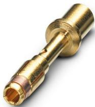
Contact à sertir, Connecteur femelle, tournés, Contact unique, diamètre de contact: 2 mm, zone de sertissage: 0,25 mm<sup>2</sup> ... 1 mm<sup>2</sup>, L'article est sans plomb, conformément à la directive RoHS II, sans exception 6c (Pb < 0,1 %)
