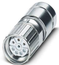
Connecteurs à câble, droit, court, Verrouillage à vis, M23, nombre de pôles: 4+3+PE, type de contact: Connecteur femelle, blindé: oui, indice de protection: IP67, plage de diamètre de câble: 11 mm ... 14 mm, nombre de pôles: 8, type de raccordement: Raccordement à sertir, série: SF, L'article est sans plomb, conformément à la directive RoHS II, sans exception 6c (Pb < 0,1 %)
