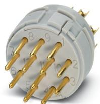
Élément de contact, M23, nombre de pôles: 16+3, type de contact: Mâle, Cône de soudage, L'article est sans plomb, conformément à la directive RoHS II, sans exception 6c (Pb < 0,1 %)
