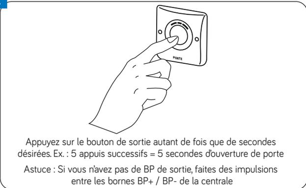
Appuyez sur le bouton de sortie autant de fois que de secondes désirées. Ex. : 5 appuis successifs = 5 secondes d'ouverture de porte
