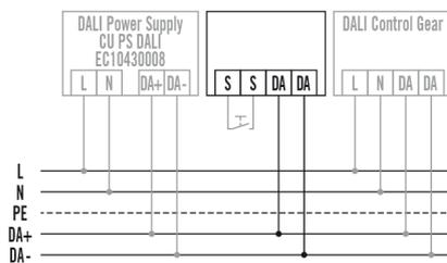
Raccordement avec commande optionnelle par poussoir.
