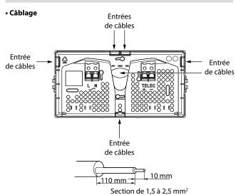
TELEC - Bornes de raccordement : pas de sens de raccordement avec la télécommande Ura réf. 140 130 /131 et 140 012. Capacité des bornes : 2 x 2,5 mm<sup>2</sup>.
