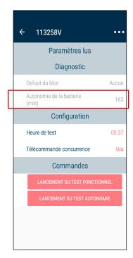
Ce paramètre permet de visualiser la durée de l'autonomie des batteries (mesurée en minute) lors du dernier test trimestriel.
