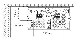
Fixation possible sur des trous existants avec un entraxe différent grâce aux alvéoles transparentes. Il est possible de fixer le fond sans l'avoir au préalable percé, il suffit de visser directement dans les alvéoles
