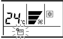
Appuyez sur le bouton ECONOMY (ÉCONOMIES) pendant au moins 2 secondes afin de sélectionner si la température de la pièce est détectée au niveau de l'appareil intérieur ou de la télécommande.
