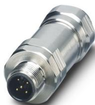
Connecteur, 5-pôles, blindé, connecteur mâle droit M12, détrompage: A, Raccordement vissé, matériau de la molette: Acier inoxydable 1.4404, presse-étoupe M16, diamètre extérieur du câble 5,5 mm ... 8,6 mm
