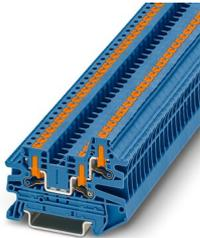
Blocs de jonction simple, tension nominale: 800 V, intensité nominale: 24 A, nombre de connexions: 3, type de raccordement: Raccordement Push-in, Section de référence: 2,5 mm<sup>2</sup>, section : 0,14 mm<sup>2</sup> - 4 mm<sup>2</sup>, type de montage: NS 35/7,5, NS 35/15, coloris: bleu
