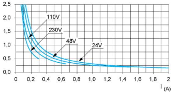
AC14 contrôle des petites charges électromagnétiques  $\leq 72$  VA, pour établir le contact :  $\cos \phi = 0,3$ , pour le couper :  $\cos \phi = 0,3$ .
