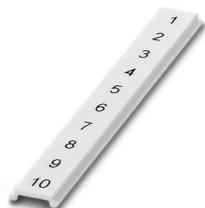
Ruban de repérage ZB, plat, Rubans, blanc, repéré, impression transversale: numérotation continue 1 ... 10, 11 ... 20, etc. jusqu'à 91 ... 100, type de montage: encliquetage, pour bloc de jonction au pas de : 5 mm, surface utile: 5,15 x 5,15 mm, Nombre d'étiquettes: 10
