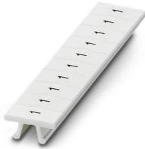
Ruban de repérage ZB, Rubans, blanc, repéré, repérable avec : CMS-P1-PLOTTER, impression longitudinale: chiffres identiques 1 ou 2, etc. jusqu'à 100, type de montage: encliquetage, pour bloc de jonction au pas de : 5,2 mm, surface utile: 5,15 x 10,5 mm, Nombre d'étiquettes: 10
