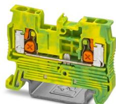
Bloc de jonction pour conducteur de protection, nombre de connexions: 2, nombre de pôles: 1, type de raccordement: Raccordement Push-X, Section de référence: 2,5 mm<sup>2</sup>, section : 0,5 mm<sup>2</sup> - 4 mm<sup>2</sup>, type de montage: NS 35/7,5, NS 35/15, coloris: vert/jaune
