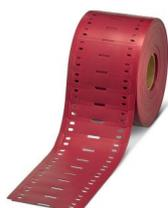
Repères pour câble, Rouleau, rouge, vierge, repérable avec : THERMOMARK E.300 (D)/600 (D), THERMOMARK ROLL 2.0, THERMOMARK ROLL, THERMOMARK ROLL X1, THERMOMARK ROLLMASTER 300/600, THERMOMARK X1.2, type de montage: Montage avec collier serrant, diamètre du câble:  $\geq 6$  mm, surface utile: 55 x 15 mm, Nombre d'étiquettes: 1000
