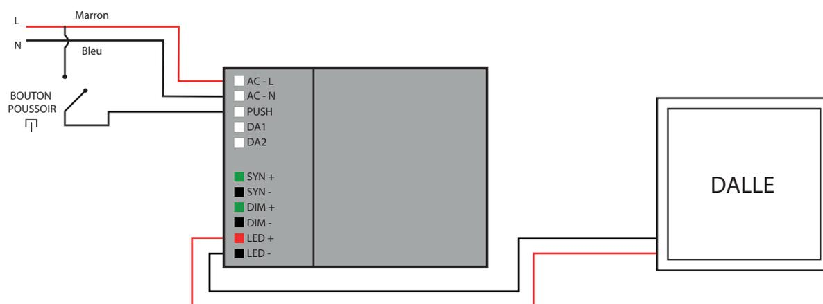
*Câblage PUSH = maximum 10 alimentations par circuit de commande*
