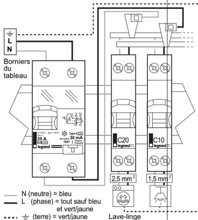
L'interrupteur différentiel doit être protégé en amont, soit par un disjoncteur de branchement Tarif bleu, soit par un fusible gG Legrand (ou un disjoncteur) de même calibre que l'interrupteur différentiel.
