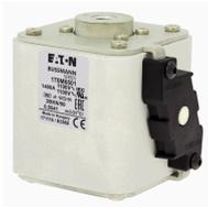
**Cartouche fusible, grande vitesse, 2000 A, AC 600 V, size 3, 74 x 92 x 90 mm, aR, IEC, indicateur de type K**
