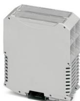
Boîtier électronique sur rail DIN, Boîtier complet avec pied métallique de verrouillage, design élancé, avec fentes d'aération, largeur: 45,2 mm, hauteur: 99 mm, profondeur: 113,65 mm, coloris: gris clair (7035), connexion transversale: Connecteur de bus sur rail DIN (en option), nombre de pôles connecteur transversal: 5
