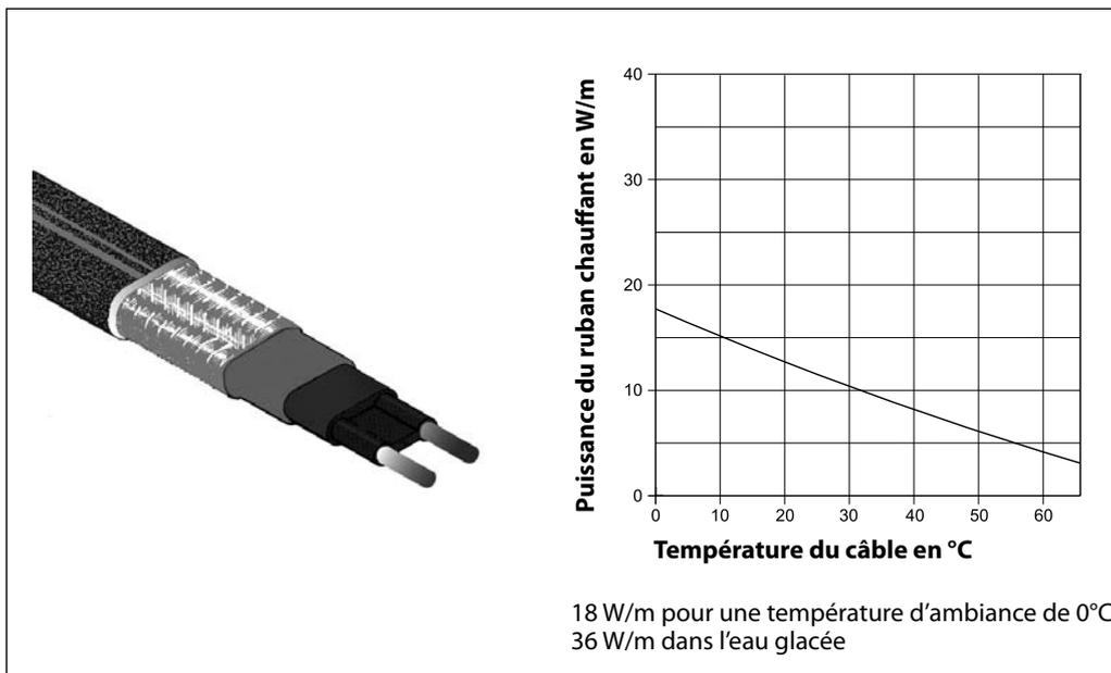
Les rubans chauffants associés autolimitants SLIG-18 sont utilisés pour protéger du gel les chéneaux, descentes de chéneaux et gouttières; ceux-ci sont particulièrement vulnérables en cas de périodes de froid prolongées et de chutes de neige, par exemple en cas d'alternance de gel et de dégel. Si les descentes de chéneaux sont gelées, l'eau de fonte peut passer au-dessus du chéneau, y former des chandelles de glace, ce
