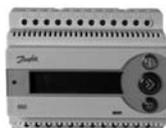
**EFIT 850 III** Détecteur digital de neige et de glace pour le montage de rails DIN servant à commander les chauffages des chéneaux et surfaces de toiture, y compris alimentation, 230 V AC / 24 V DC, sans sonde, IP 30, puissance absorbée 16 A
