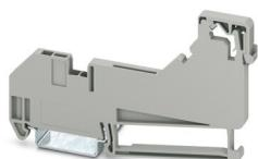
Support isolant, Support pour barres collectrices, à poser tous les 20 cm, largeur: 5,2 mm, hauteur: 102,4 mm, nombre de pôles: 1, coloris: gris, type de montage: Montage sur profilé
