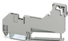
Support isolant, Support pour barres collectrices, à poser tous les 20 cm, largeur: 5,2 mm, hauteur: 102,4 mm, nombre de pôles: 2, coloris: gris, type de montage: Montage sur profilé
