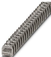
Bloc de jonction, type de raccordement: Raccordement vissé, Section de référence: 4 mm<sup>2</sup>, section : 0,5 mm<sup>2</sup> - 6 mm<sup>2</sup>, montage: Barre collectrice de N, coloris: argent
