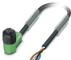
Câble pour capteurs/actionneurs, 4-pôles exempt d'halogène, extrémité libre, sur Connecteur femelle coudé M12, détrompage: A, longueur de câble: 3 m, avec molette plastique
